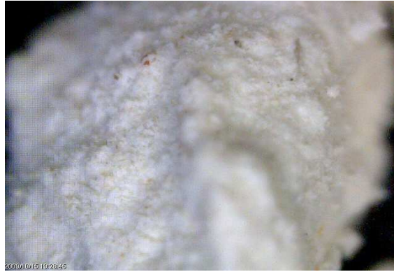
Gambar 1. Serpihan Zeolit Lampung yang Diambil Melalui Digital Image dengan Perbesaran 200 Kali
