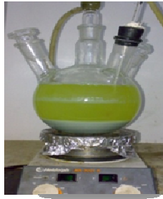
Gambar 1. Proses Perlakuan Zeolit Menggunakan HCl 1,5 M (direfluks selama 5 jam pada kecepatan putar 300 rpm)
