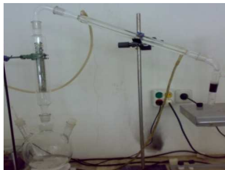
Gambar 5. Rangkaian Alat yang Digunakan pada Proses Dehidrasi Bioetanol
